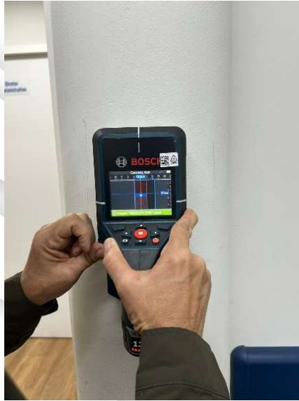
Figura 5: Procedimento do ensaio de pacometria
