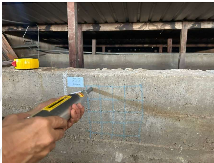
Figura 7: Procedimento do ensaio de Esclerometria
